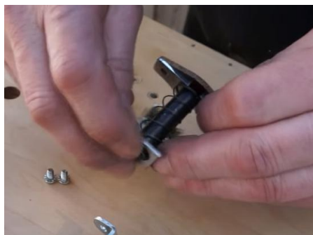
Inizia l'inserimento del pistone dentro la staffa supporto bobina
