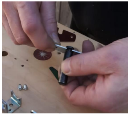
Inseriamo il giogo metallico sulla scanalatura del pistone
