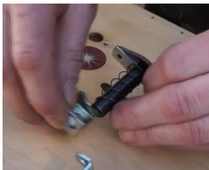
Inizia l'inserimento del pistone dentro la staffa supporto bobina
