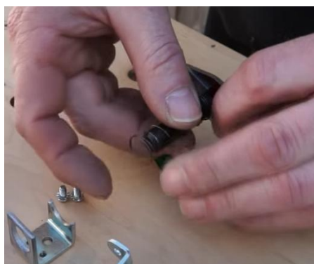
Facciamo passare il pistone scanalato dentro la molla
