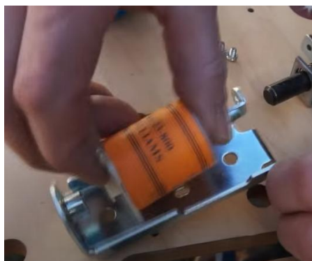
Inseriamo la bobina con il suo canotto di plastica in fondo alla staffa fissaggio bobina
